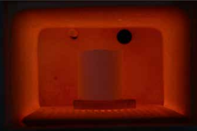
08 Nach dem Abbinden wurde die Einbett- masse-Muffel im Vorwärmofen auf die ge- wünschte Presstemperatur aufgeheizt
