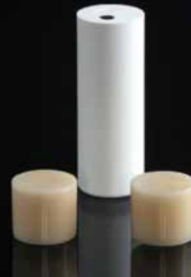
09 Die Pressung der beiden Vollkeramik- kronen 45, 46 erfolgte mit zwei DA2 Pressrohlingen (wahlweise in 2 oder 3 g)
