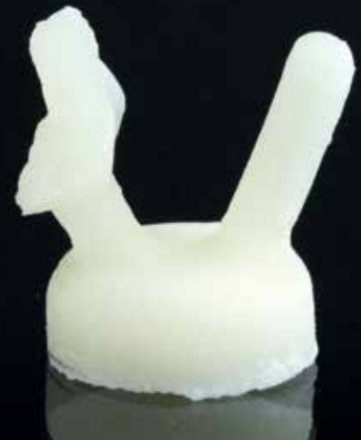
12 Die verbliebene Reaktionsschicht ließ sich mit 50 µm Aluminiumoxid vollständig entfernen, sodass nicht abgesäuert werden musste
