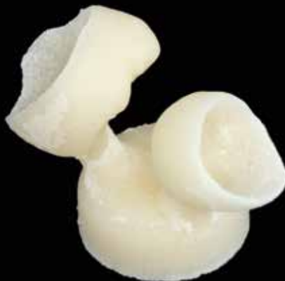
10 & 11 Die Pressobjekte wurden nach dem Entfernen des Pressstempels und der überschüssigen Einbettmasse mit Glanzstrahlperlen grob abgestrahlt
